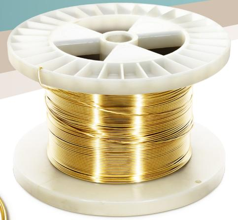
El oro relleno utiliza una capa de oro en quilates que luego se une a un núcleo interno de latón. JK Findings fabrica oro relleno de 14 quilates, lo que significa que tiene un 5% de oro de 14 quilates por unidad de peso con un núcleo de latón.
